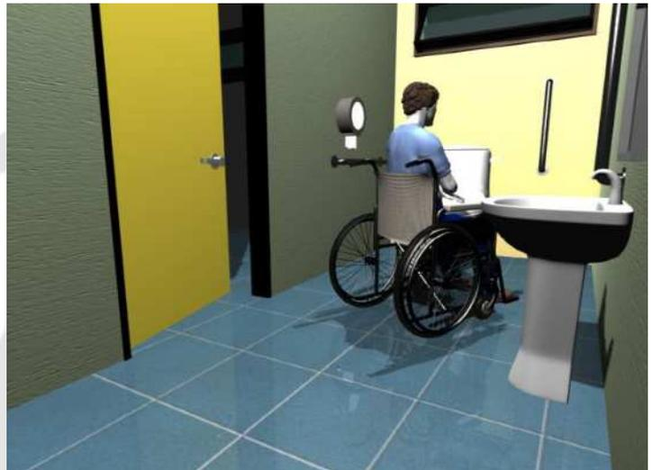
El ancho mínimo de la entrada debe ser de 90 cm, la puerta debe abrir hacia afuera o ser plegable, y como se señala en el apartado de puertas, debe contar con manijas de tipo palanca, ubicadas a una altura de 90 cm, de manera que puedan ser accionadas con poco esfuerzo con una sola mano, codo, pierna o mandíbula según sea del caso.
