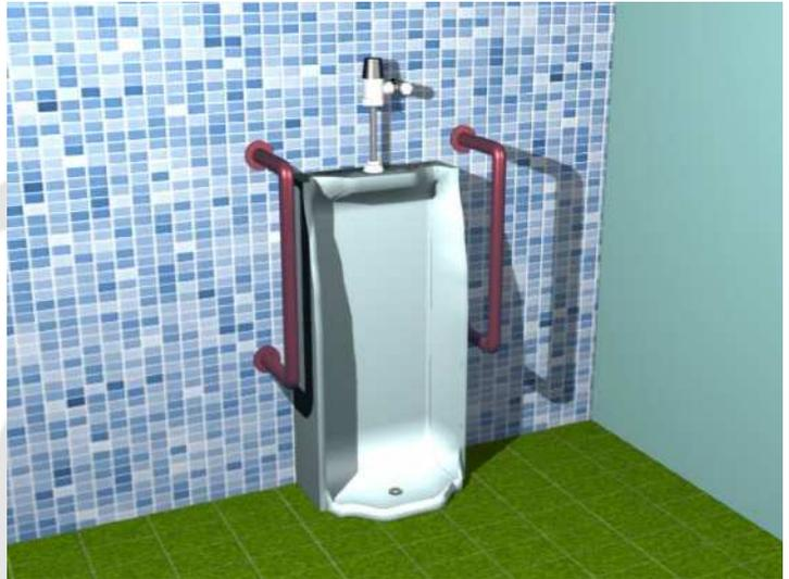
El dispositivo de descarga del aparato sanitario deberá estar ubicado a una altura máxima de 110 cm, y ser accionable por presión, palanca o de forma automática.
