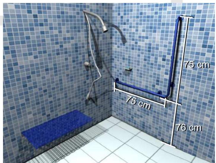
Como parte de los accesorios, tiene que tener como mínimo una jabonera a una altura máxima de 90 cm y tres percheros siendo uno de ellos específico para muletas, ortesis y similares a una altura de 120 cm, todos medidos desde el nivel del piso terminado, además es recomendable que cuente con una ducha del tipo teléfono, para que facilite su uso desde una posición sentada.
