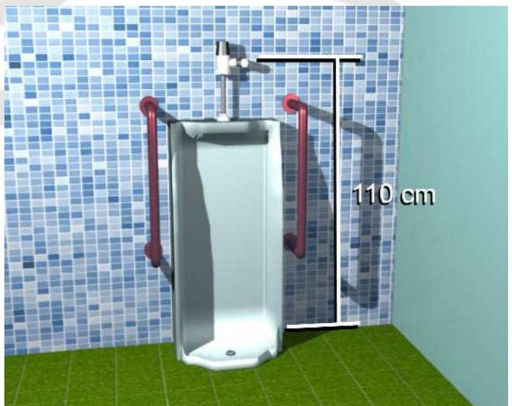
El mingitorio debe disponer de dos agarraderas verticales de 80 cm de longitud, separadas por 80 cm entre ellas y deberán separarse 30 cm de la pared de fondo ubicándose a una altura de 70 cm desde el nivel del piso terminado.
