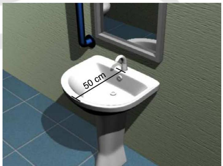
Las tuberías deben situarse a 25 cm mínimo desde el borde del lavatorio y contar con dispositivos de protección o de material adecuado que evite quemaduras.
