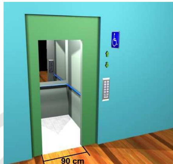
Por seguridad, no debe existir una abertura superior a los 2 cm entre el carro y el piso, además de que debe tener una exactitud de 2 cm máximo entre el piso del edificio y el piso del elevador.
