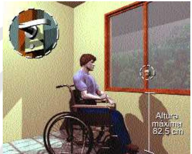
Todos los dispositivos como contactos, cajeros automáticos, apagadores eléctricos, picaportes, alarmas, control de temperatura u otros análogos incluyendo timbres, deben ubicarse a una altura comprendida, entre los 90 cm y los 120 cm desde el piso terminado, de manera que faciliten su utilización aún desde una posición sentada.
