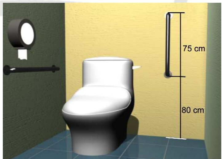
Debe contar además con una agarradera horizontal la cual tendrá 90 cm mínimo de longitud y estará ubicada lateral al inodoro, a una altura de 30 cm por encima del asiento del aparato y a una distancia de 32 cm entre los ejes.
