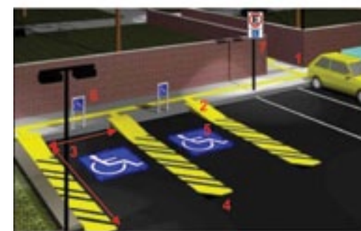
Figura 6. Configuración básica de estacionamiento accesible.
